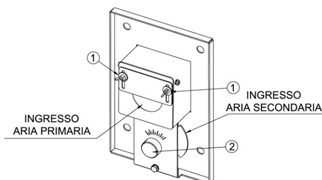
L'aria di combustione per la caldaia a legna affluisce attraverso il condotto di aspirazione. Il flusso immesso viene poi convogliato in due canali separati detti "aria primaria" e "aria secondaria".
