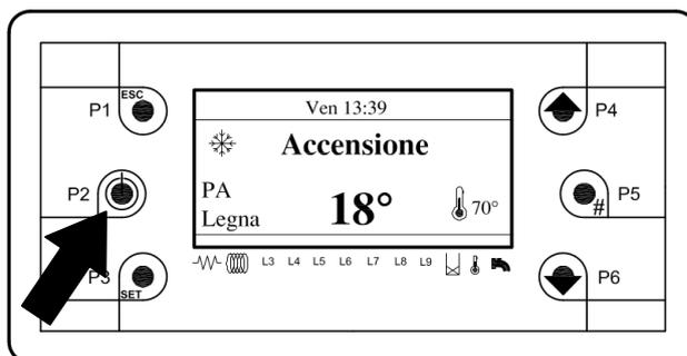
Nel momento in cui viene avviato il ciclo di funzionamento sul display superiore compare la scritta **“Accensione”** indicante la fase di accensione caldaia. Questa scritta rimarrà sul display finchè la temperatura dei fumi non supera la *minima temperatura fumi in accensione* (tarata a 70°) nel tempo impostato dal parametro *tempo fase di accensione* (tarato a 30 minuti) ; in questo stato il ventilatore funziona alla massima velocità.
