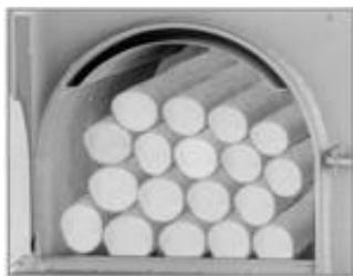
Formado el lecho de brasas se puede proceder a la carga de la leña. Abrir lentamente la puerta del almacén de leña, para que el ventilador aspire los humos acumulados en el almacén de leña. Utilizando el atizador, abrir lentamente la puerta anti humos y distribuir uniformemente las brasas sobre la piedra principal. Se podrá después proceder a la carga de la leña, que deberá hacerse con trocos de la longitud máxima que permita el hogar.
