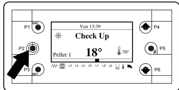
Nel momento in cui viene avviato il ciclo di funzionamento sul display superiore compare la scritta “Check Up” e parte il ventilatore alla massima velocità per effettuare una pulizia iniziale del boccaglio del bruciatore a pellet. Il led L7 è illuminato in quanto in questa fase è attiva la valvola aria per la pulizia del boccaglio del bruciatore (solo su modelli 14, 20, 30, 40 e 50). Questa fase ha durata di 2 minuti.
