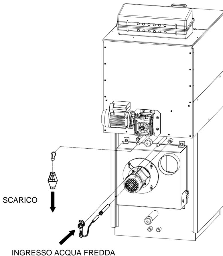
**! IMPORTANTE:** si consiglia di installare la valvola di scarico termico in direzione ingresso del serpentino e prevedere in corrispondenza all'uscita scambiatore un tubo di scarico.
