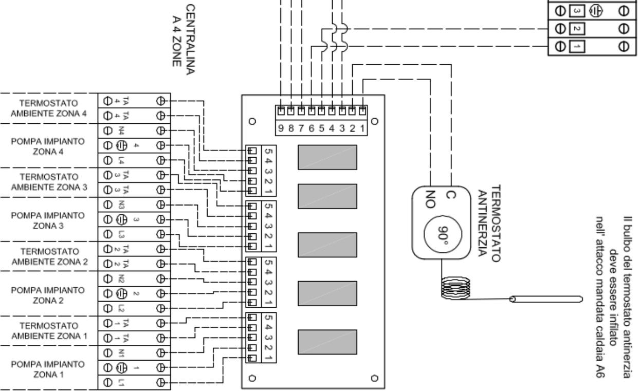
Il bulbo del termostato antinerzia deve essere inflato nell' attacco mandata caldaia A6
