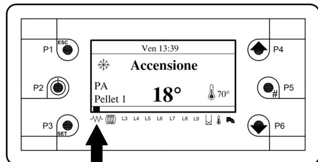
Questa è la fase di preriscaldamento della resistenza di accensione, sul display si illumina il led  $\sim\sim\sim$ . Ha durata di 2 minuti e il ventilatore passa alla minima velocità.
