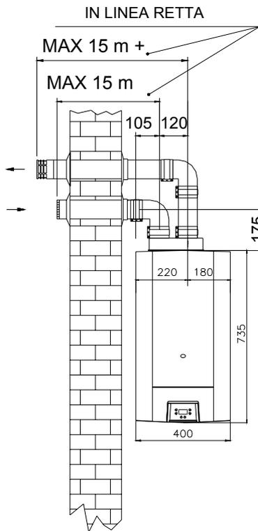
N.B.: La somma della lunghezza del tubo di scarico e quella del tubo di aspirazione non deve superare i 30 metri.
