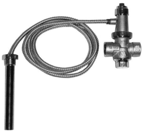
La valvola, indipendentemente dalla pressione, si apre quando la temperatura del circuito primario raggiunge circa i 95°C. L'apertura della valvola comporta un costante scarico di acqua che impedisce alla temperatura di raggiungere i 110°C.
