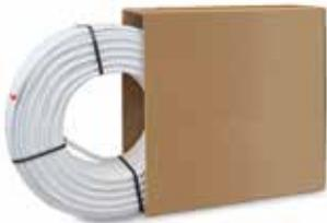
Tubo multistrato MULTYLAYER (PE-Xb/Al/PE-Xb conforme alle classi 1 - 2 - 4 e 5 della norma UNI-EN ISO 21003 e DIN 4726. Composto da un doppio strato interno ed esterno in polietilene reticolato PE-Xb (metodo B ai silani) legati tramite speciale adesivo ad uno strato intermedio in lega di alluminio saldato longitudinalmente (TIG testa a testa). Garantisce un alto livello di modellabilità della struttura, completa barriera all'ossigeno,
