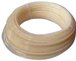
Materiale: Tubazione per riscaldamento e raffreddamento a pavimento in polietilene reticolato PEX ad alta densità PE-XA, conforme EN ISO15875, realizzato con barriera anti diffusione dell'ossigeno in EVOH costruito secondo DIN 4726 a tre strati; è certificato con codice identificativo AENOR 001/640.
