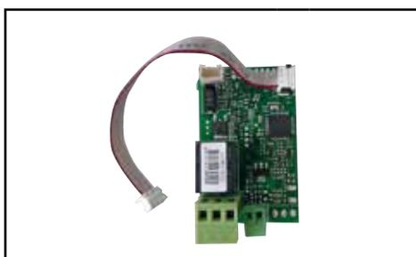
CENTRALINA DI ZONA abbinabile a remoto Classe V (per gestire n TA e n zone) compatibile con scheda MX monolettrodo
