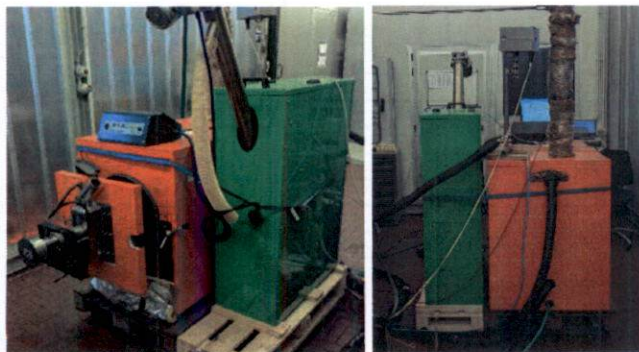
Figura 1A e 1B: Caldaia sottoposta a prova presso il laboratorio LEAP
