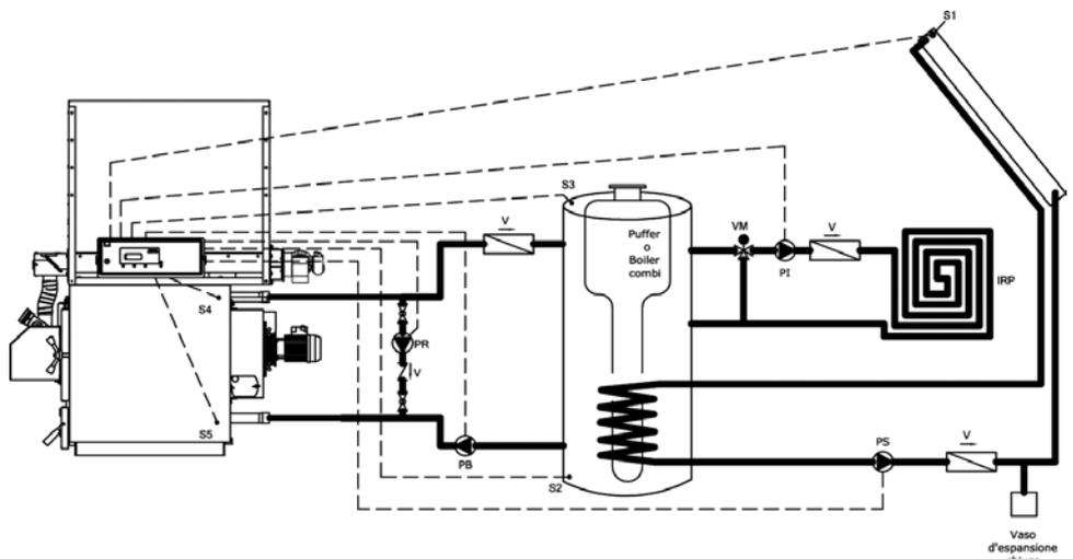
Schemi idraulici per sistemi complessi. In presenza di caldaia murale e fonte solare o biomassa, STEP dispone di un innovativo sistema brevettato ad elevata efficienza: il sistema SUN. Per ulteriori dettagli dello schema SUN visita il sito [www.stepclima.com](http://www.stepclima.com)
