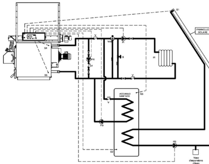
Con solare per integrazione riscaldamento (consigliato solo in presenza di impianto a pavimento) con puffer combi.
