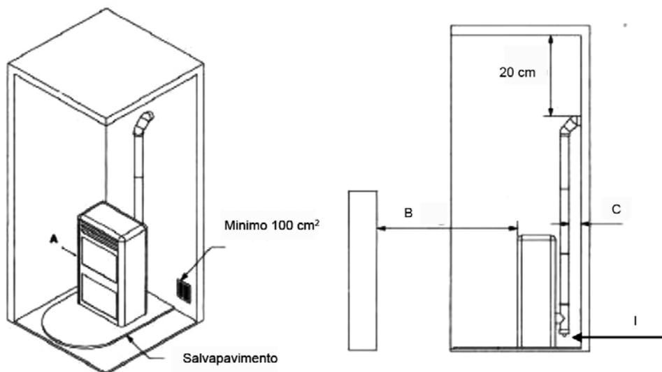
E' consigliato che il condotto fumario sia dotato di una camera di raccolta di materiali solidi ed eventuali condense situata sotto l'imbocco del canale da fumo, in modo da essere facilmente apribile ed ispezionabile da sportello a tenuta di fumi ad alta temperatura.
