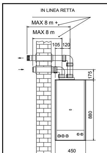
N.B.: La somma della lunghezza del tubo di scarico e quella del tubo di aspirazione non deve superare i 16 metri. Per ogni curva aggiunta la lunghezza massima consentita deve essere diminuita di 1 metro.
