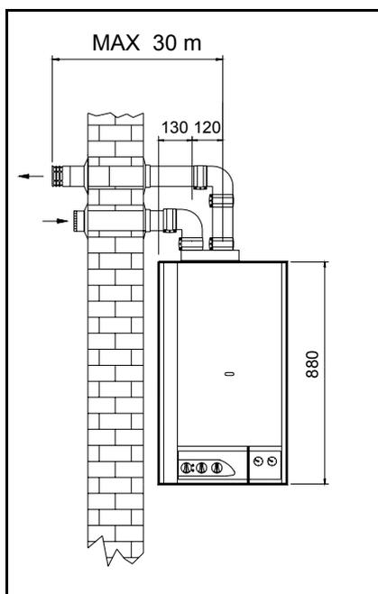
N.B.: La somma della lunghezza del tubo di scarico e quella del tubo di aspirazione non deve superare i 30 metri. Per ogni curva aggiunta la lunghezza massima consentita deve essere diminuita di 1 metro.
