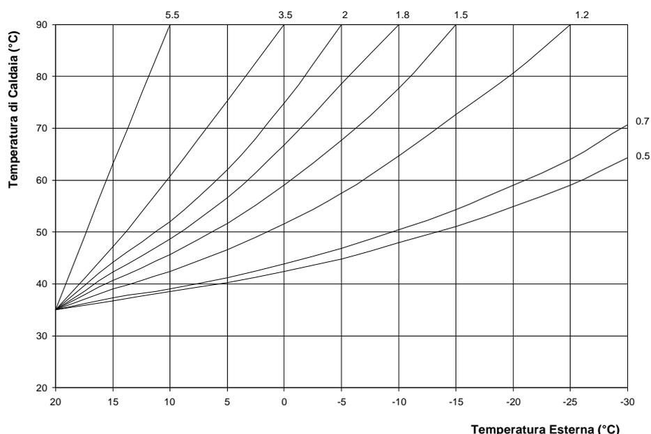
Il fattore "K" che identifica ogni curva è quello evidenziato al termine delle stesse. Per impostare il fattore "K" agire sul trimmer che si trova sotto la manopola del riscaldamento ②.
