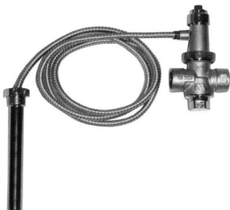
La valvola, indipendentemente dalla pressione, si apre quando la temperatura del circuito primario raggiunge circa i 95°C. L'apertura della valvola comporta un costante scarico di acqua che impedisce alla temperatura di raggiungere i 110°C.
