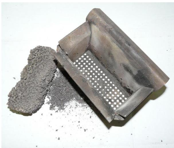
Un crogio malamente pulito può essere causa di una cattiva combustione con il rischio di un innalzamento della temperatura di esercizio della stufa e con conseguente possibile il surriscaldamento della stessa (vedi immagine affianco cestello incrostato dalla formazione di sedimento).
