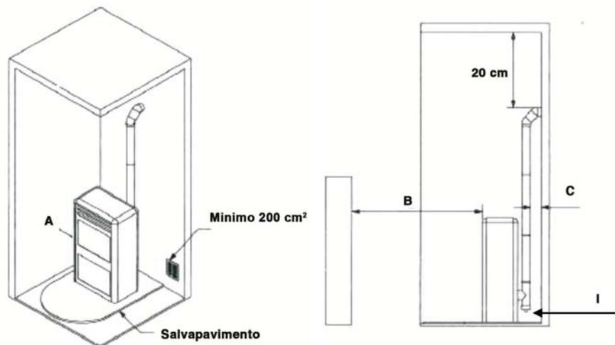
**Nel caso cui non sia possibile realizzare la presa di aspirazione è possibile prelevare l'aria dall'esterno tramite un prolungamento del tubo di aspirazione presente dietro la stufa. Il tubo deve essere diametro 80 e non deve presentare curve.**
