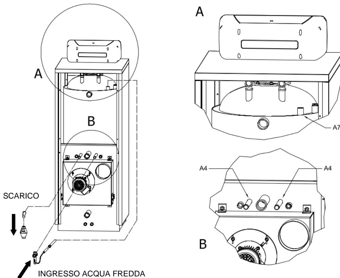
**! IMPORTANTE:** si consiglia di installare la valvola di scarico termico in direzione ingresso del serpentino e prevedere in corrispondenza all'uscita scambiatore un tubo di scarico.
