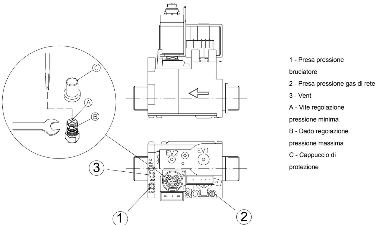
Per eseguire il controllo delle pressioni al bruciatore, inserire le sonde del manometro nelle prese di pressione disponibili sulla valvola gas (vedi fig.).
