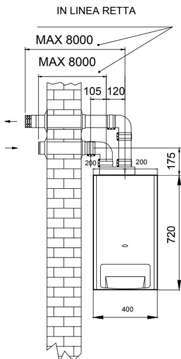
I tubi di aspirazione e scarico vanno montati con leggera pendenza verso l'esterno.
