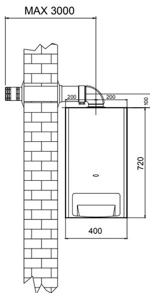
Il tubo di aspirazione e scarico va montato con leggera pendenza verso l'esterno.
