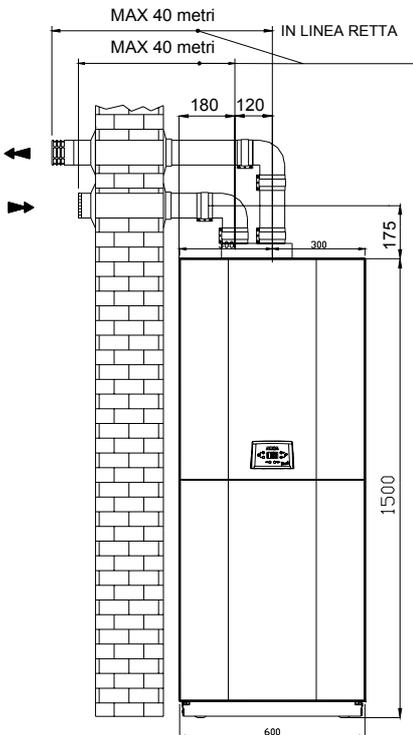
N.B.: La somma della lunghezza del tubo di scarico e quella del tubo di aspirazione non deve superare 80 metri.
