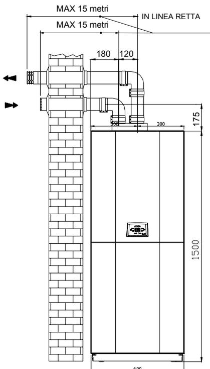
N.B.: La somma della lunghezza del tubo di scarico e quella del tubo di aspirazione non deve superare i 30 metri.
