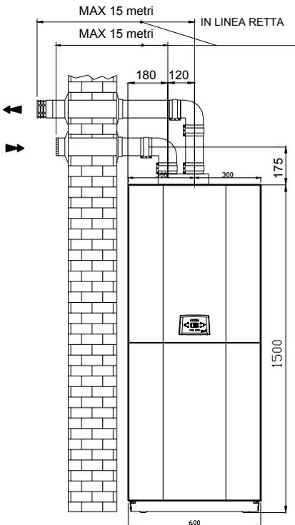
N.B.: La somma della lunghezza del tubo di scarico e quella del tubo di aspirazione non deve superare i 16 metri.
